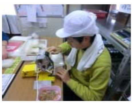
新しく導入された「ホットプリンター」賞味期限を印字していきます。
